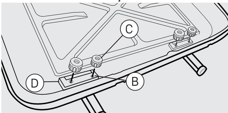
Monte as peças B, C e D conforme a figura acima, firmando bem o bagageiro no rack. Feche a tampa e tranque o bagageiro girando a chave no sentido horário.
