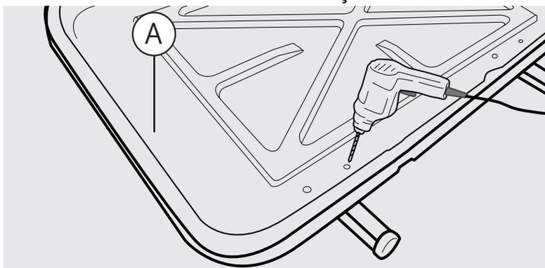
Posicione o rack entre um dos pares de marcação de furos.\* Em seguida, faça os furos selecionados com broca 10mm.\*\* Repita o processo para os outros 3 pontos de fixação.
